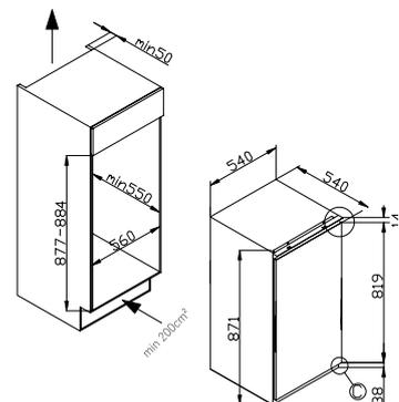
Einbau-Vollraum-Kühlschrank 880 mm
