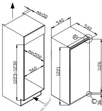
Einbau-Vollraum-Kühlschrank 1220 mm
