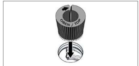
Abb. 9.8 Geruchsfilter in Abzugsöffnung einsetzen
