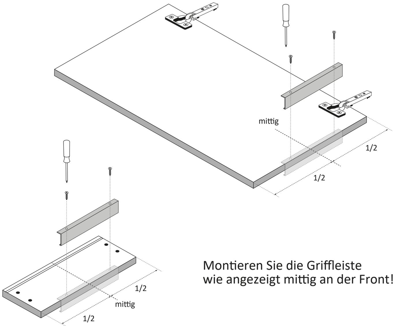
Montieren Sie die Griffleiste wie angezeigt mittig an der Front!
