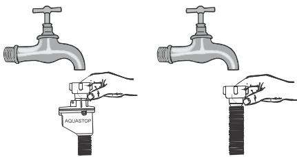
**HINWEIS:** Einige Geschirrspülermodelle verfügen über einen Zulaufschlauch mit Aquastop. Bei Einsatz von Aquastop kommt gefährliche Spannung vor. Schneiden Sie die Wasserzuführung Aquastop nicht durch. Lassen Sie nicht zu, dass die Wasserzulaufleitung einrollt oder knickt.
