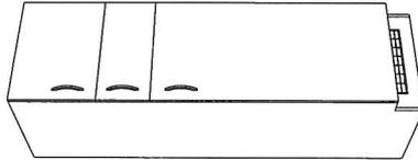
Lüftungsgitter für den Sockelausschnitt beim Kühlschrank
