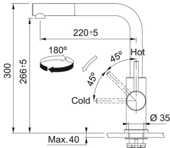
Smart Glenda Zugauslauf, Edelstahl Durchflussleistung: 9,0 l/Min., Energieklasse: B, Schwenkbereich 180 °, Schlauchlänge 50 cm
