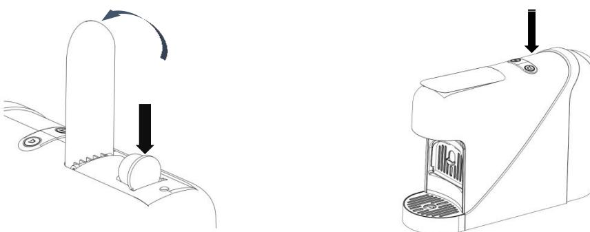
Ist während der Kaffeezubereitung zu wenig Wasser im Wasserbehälter, stoppt die Maschine automatisch und die Kontrollleuchte blinkt schnell. Füllen Sie das Wasser in den Behälter und drücken Sie zum Fortsetzen der Kaffeezubereitung die entsprechende Taste. Beachten Sie das Fassungsvermögen der Tasse, um ein Überlaufen zu vermeiden.
