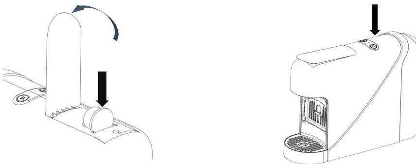
Pokud je během přípravy kávy v nádržce málo vody, kávovar se automaticky zastaví a kontrolka začne rychle blikat. Doplňte vodu do nádržky a stiskněte odpovídající tlačítka po pokračování v
