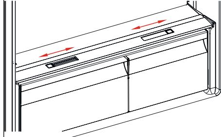
Si le compartiment à légumes est plein, le réglage flux d'air situé à l'avant du compartiment doit être ouvert. Ceci permet la pénétration de l'air dans le compartiment à légumes et le contrôle du taux d'humidité
