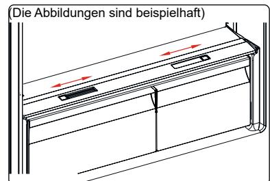
Bei vollem Gemüsefach sollte der Frischeregler vorne am Gemüsefach geöffnet werden. So kann die Luft und die Feuchtigkeit im Gemüsefach reguliert werden, um die Haltbarkeit der Lebensmittel im Fach zu verlängern. Wenn sich Kondenswasser am Glasablagefach bildet, muss der Frischeregler hinter dem Fach geöffnet werden.
