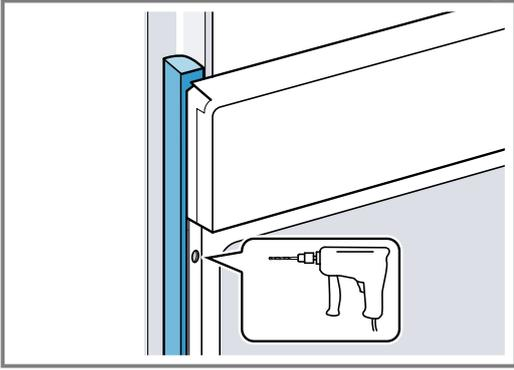
4. Das Gerät mit adäquater Schraube befestigen.
