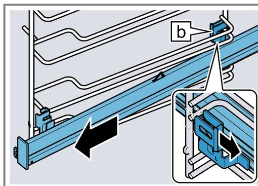
4. Die Auszugsschiene entfernen.
