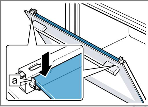
5. Die Gerätetür öffnen und Türdichtung einhängen.
