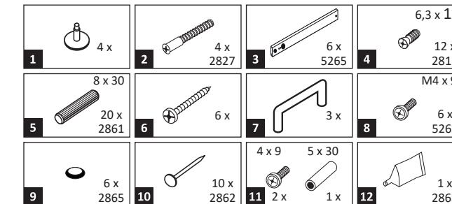
Das beigelegte Wandbefestigungsmaterial (Dübel und Schrauben) eignet sich nur für festes Mauerwerk (z.B.: Beton- oder Ziegelwände). Für andere Wandaufbauten sind eventuell Spezialdübel und andere Schrauben notwendig. Ziehen Sie gegebenenfalls eine Fachkraft zu Rate.
