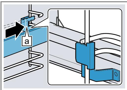
3. **PUSH** gedrückt halten ① und die Auszugsschiene nach innen schwenken, bis sich die Halterung [a] vorn zwischen den beiden Stäben befindet ②.
