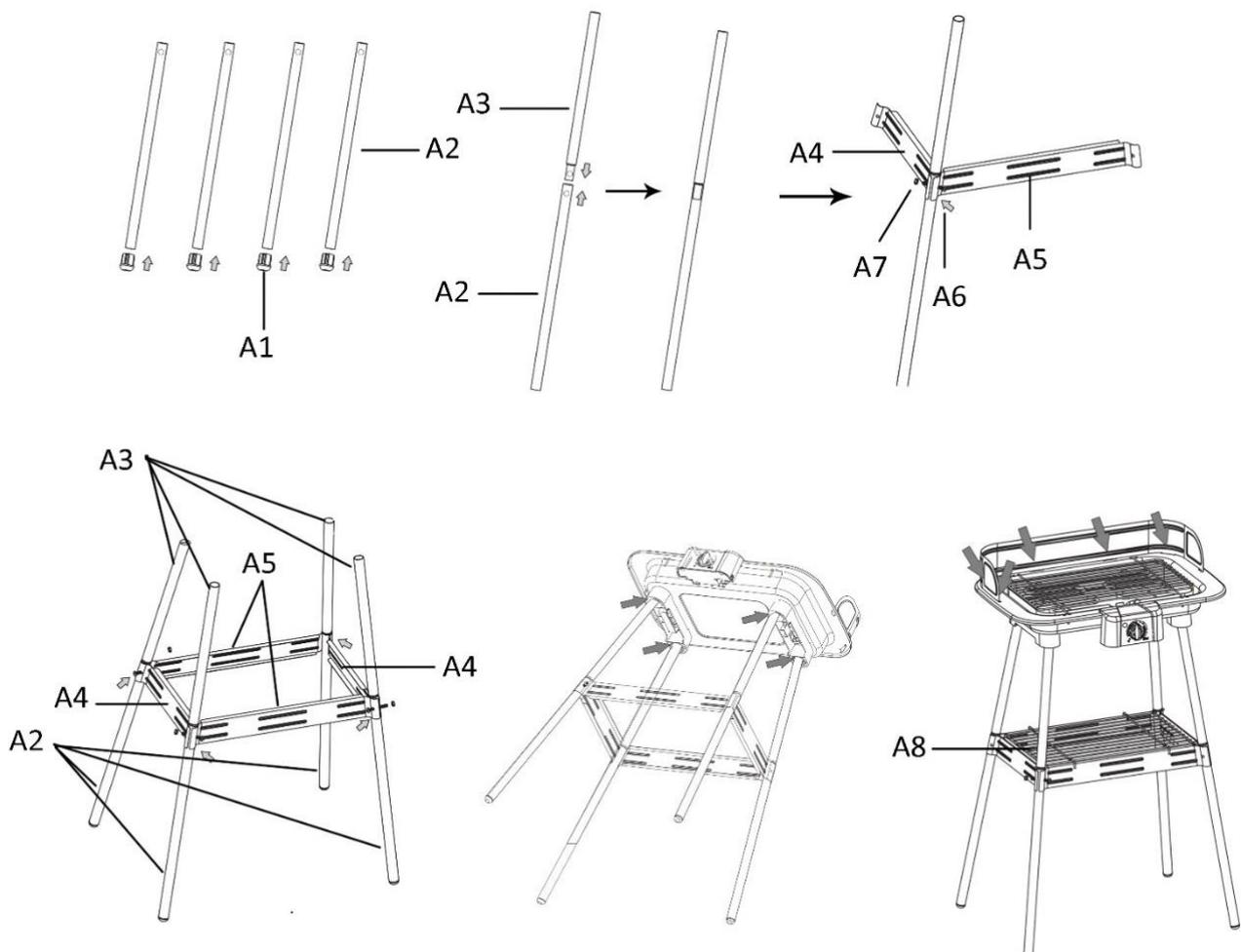
1. Stecken Sie 4 Anschlussstücke (A1) jeweils in das Ende Öffnungen der langen Rohre.
