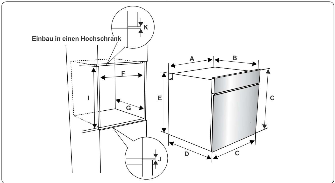
Nachdem alle elektrischen Anschlüsse ausgeführt wurden, den Backofen in den Einbauschränk einschieben. Die Backofentür öffnen, und die 2 Schrauben in die Löcher im Rahmen des Backofens einschrauben. Bei an der Schrankoberfläche anliegendem Geräteraum die Schrauben festziehen.
