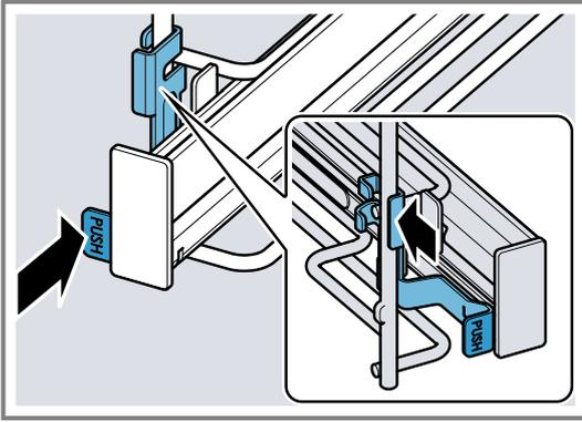
2. **PUSH** gedrückt halten ① und die Schiene nach außen schwenken ②, bis die vordere Halterung ③ ausgehängt ist.
