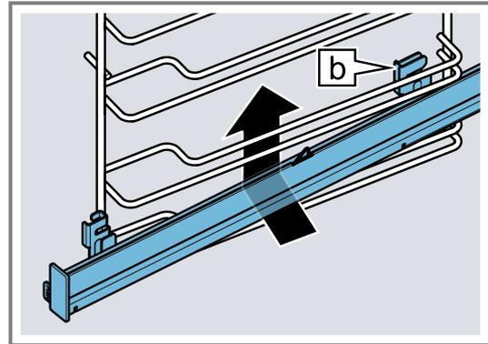
2. Die Schiene längs zu den Führungsstäben nach hinten führen und beide Halterungen jeweils auf den unteren Stab aufschieben. Dabei mit der hinteren Halterung ④ den senkrechten Stab umgreifen.
