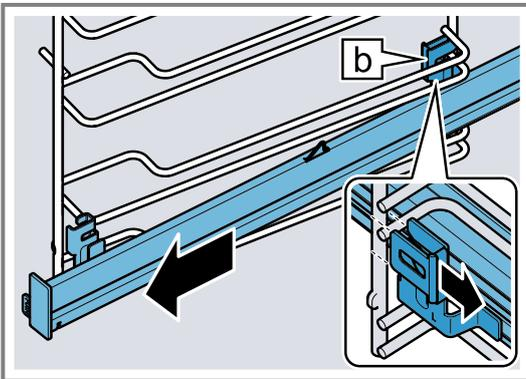
4. Die Auszugsschiene entfernen.
