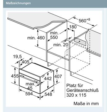
min. 550 min. 35 450<sup>+2</sup> min. 35 407 560+8 max Platz für Geräteanschluß 320 x 115 Maße in mm
