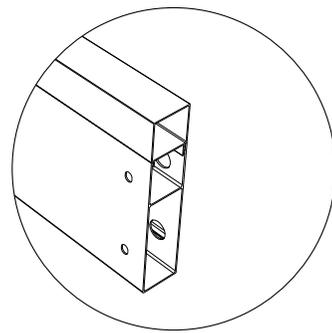
Überprüfen Sie die Größe. Bohren Sie mit einem Ø12-mm-Bohrer Löcher an der Stelle, an der die Stahlplatte befestigt werden soll und befestigen Sie diese dann mit **TO**. Verwenden einen M17-Schlüssel zum Befestigen von **TO**.
