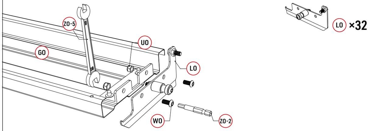
Montieren Sie die beiden Verbindungsstücke auf beiden Enden der Lamellen.
