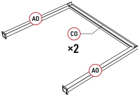
1. Legen Sie die Säule und den Balken flach hin und geben Sie **CO** in die Rille des abgeschlossene Spalte **AO**.
