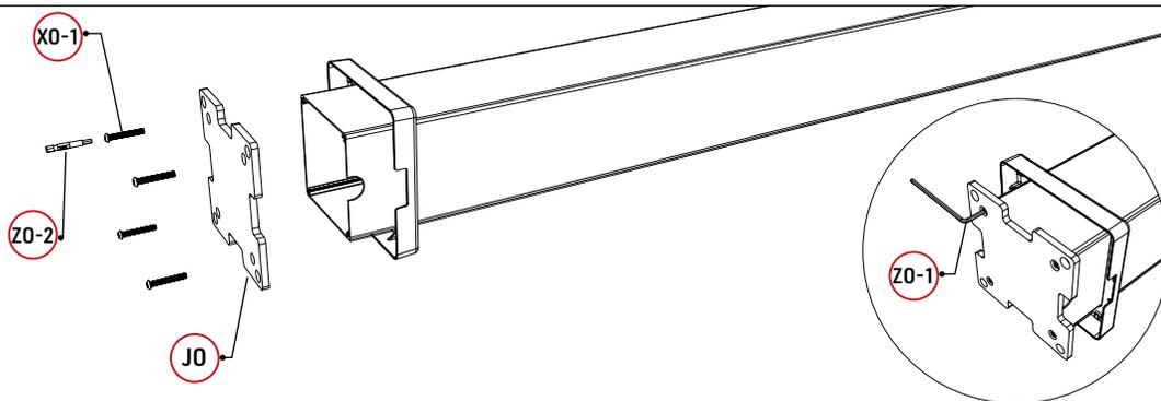
2. Befestigen Sie die **J0**-Grundplatte mit **X0-1** an der Unterseite der Säule und ziehen Sie sie mit dem Sechskantschlüssel **Z0-1** manuell fest.
