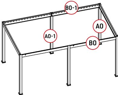
1. Legen Sie die Säule und den Balken flach hin und geben Sie **BO-1** in die Rille des abgeschlossene Spalte **AO**.
