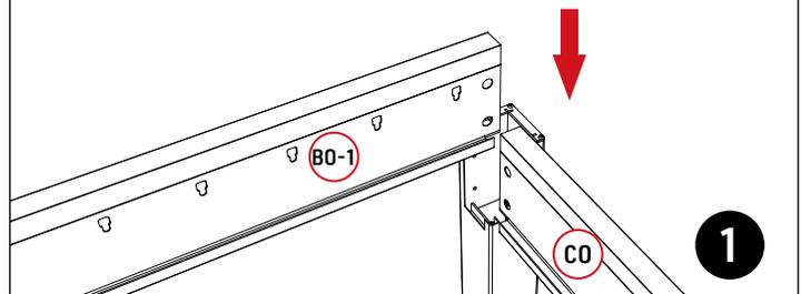
2. Verbinden Sie mithilfe von **Q0**, **BO-1** und **AO** miteinander. Verwenden Sie zum manuellen festziehen den Inbusschlüssel **Z0-3**.
