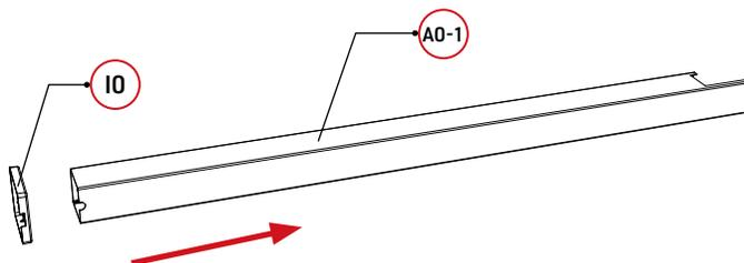
1. Platzieren Sie **I0** in **A0-1**, stellen Sie sicher, dass die Kerbe um die Säulen **I0** mit dem Abflussauslass ausgerichtet zum Boden der **A0**-Säule ist und platzieren Sie es in der Säule.
