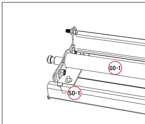
Montieren Sie **S0-1** an beiden Enden der Lamellen.
