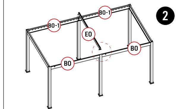
3. Achten Sie auf die Richtung von **EO**. Befestigen Sie den **XO-3** mit dem Werkzeug **ZO-2** an der Mittelsäule.
