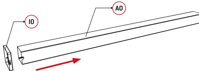
1. Platzieren Sie **I0** in **A0**, stellen Sie sicher, dass die Kerbe um die Säulen **I0** mit dem Abflussauslass ausgerichtet zum Boden der **A0**-Säule ist und platzieren Sie es in der Säule.
