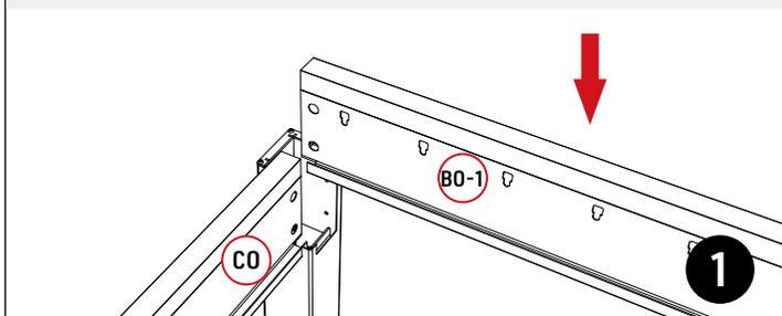
2. Verbinden Sie mithilfe von **Q0**, **BO-1** und **AO** miteinander. Verwenden Sie zum manuellen festziehen den Inbusschlüssel **Z0-3**.
