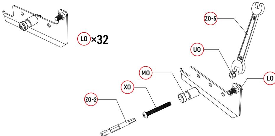
Verwende **Z0-5** um **U0** zu befestigen und die Montage des **LO** abzuschließen.
