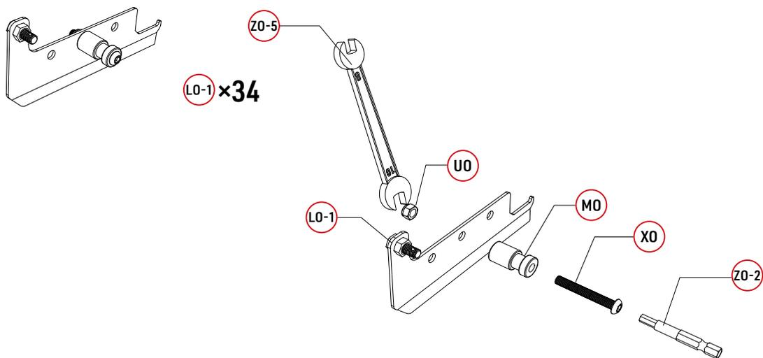
Verwende **Z0-5** um **U0** zu befestigen und die Montage des **LO** abzuschließen.
