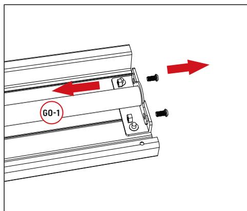
Montieren Sie die beiden Verbindungsstücke auf beiden Enden der Lamellen.
