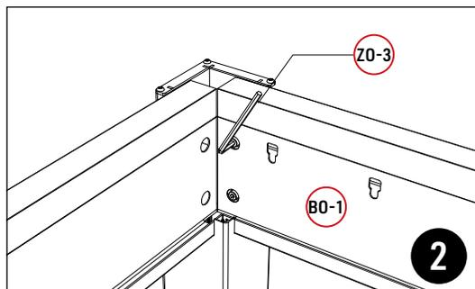
3. Verbinden Sie mithilfe von **Q0**, **BO-1** und **AO-1** miteinander. Verwenden Sie zum manuellen Festziehen den Inbusschlüssel **Z0-3**. **BO** wird auf die gleiche Weise aufgebaut.
