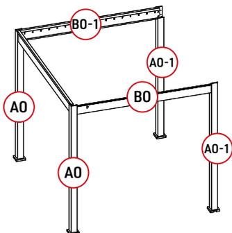
1. Legen Sie die Säule und den Balken flach hin und geben Sie **BO-1** in die Rille des abgeschlossene Spalte **AO**.
