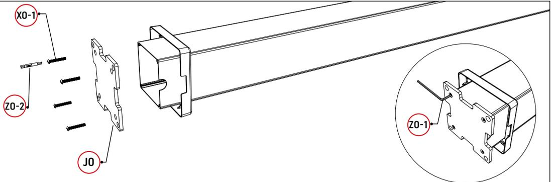
2. Befestigen Sie die **J0**-Grundplatte mit **X0-1** an der Unterseite der Säule und ziehen Sie sie mit dem Sechskantschlüssel **Z0-1** manuell fest.
