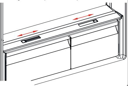
Si le compartiment à légumes est plein, le réglage flux d'air situé à l'avant du compartiment doit être ouvert. Ceci permet la pénétration de l'air dans le compartiment à légumes et le contrôle du taux d'humidité afin d'augmenter la durée de vie des aliments.
