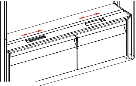
Bei vollem Gemüsefach sollte der Frischeregler vorne am Gemüsefach geöffnet werden. So kann die Luft und die Feuchtigkeit im Gemüsefach
