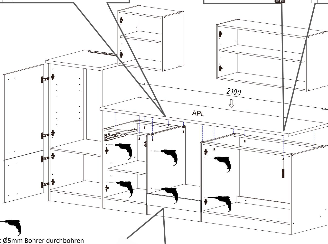
Mit Ø5mm Bohrer durchbohren
