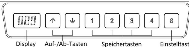
Das Bedienfeld besteht aus mehreren Tasten. Wenn innerhalb von 30 Sekunden keine Taste gedrückt wird, werden das Display und die Tasten 1/2/3/4/5 entsprechend gesperrt. Zur Vornahme von Einstellungen sind zuerst die Aufwärts- oder Abwärtstaste zu drücken. Das Bedienfeld ist zur Eingabe bereit, wenn das Display aufleuchtet.
