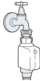
tuyau d'alimentation de sécurité
