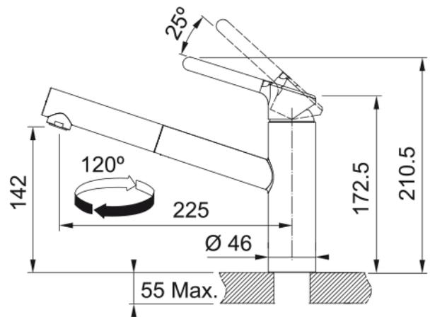
Orbit Zugauslauf, Chrom, Niederdruck, Easy Installation, Eco, Silent, Schwenkbereich 120°, Obenbedienung, Schlauchlänge 45 cm
