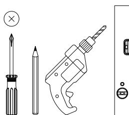
**DE Montagehinweise:** Vor dem Bohren den Verlauf von Strom- und Wasserleitungen unbedingt überprüfen und berücksichtigen! Bei der Wandmontage ist darauf zu achten, dass der Schrank nicht auf leitfähigen Oberflächen und nur am festen Mauerwerk montiert wird. Das beiliegende Montagematerial ist geeignet für übliches, festes Mauerwerk. Informieren Sie sich vor der Wandmontage über das geeignete Montagematerial für Ihre Wand und tauschen Sie es ggf. aus.
