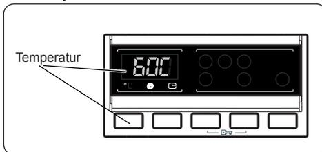
Betätigen Sie die Wassertemperatur-Einstelltaste, um die automatisch eingestellte Temperatur des jeweiligen Waschprogramms zu ändern.
