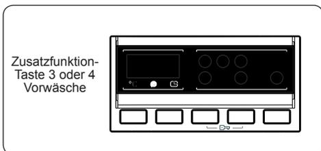
Mit dieser Zusatzfunktion kann stark verschmutzte Wäsche vor der Hauptwäsche einem Vorwaschgang unterzogen werden. Bei Verwendung dieser Funktion muss Waschmittel in die erste Kammer des Waschmittel-Einspülkastens gefüllt werden.
