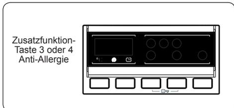
Mit dieser Funktion kann ein zusätzlicher Spülvorgang ausgeführt werden. Bei der Zusatzfunktion „Antiallergisch“ erfolgen alle Spülschritte unter Verwendung von warmem Wasser. Die Verwendung dieser Zusatzfunktion wird bei empfindlicher Haut, für Babykleidung und für Unterwäsche empfohlen.
