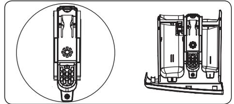
Diese Kammer dient der Aufnahme von Weichspüler, Formspüler oder Stärke. Befolgen Sie die Anweisungen auf der entsprechenden Produktverpackung. Falls die Wäsche nach dem Waschen Weichspüllerrückstände aufweisen sollte, empfehlen wir, das Pulver vor der Wäsche in Wasser aufzulösen bzw. einen Flüssigweichspüler zu verwenden.
