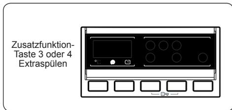
Mit dieser Zusatzfunktion kann am Ende des gewählten Waschprogramms ein zusätzlicher Spülvorgang ausgeführt werden.
