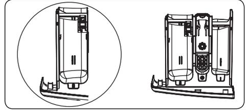
Diese Kammer dient der Aufnahme von Flüssig-/Pulverwaschmittel und Wasserenthärter. Der Einsatz für Flüssigwaschmittel befindet sich bei Lieferung im Gerät. (\*)
