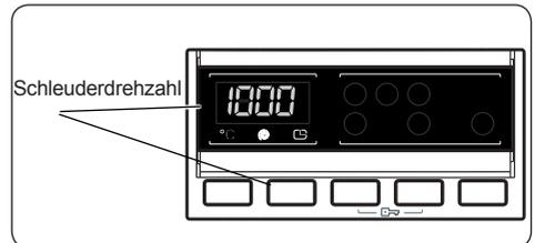
Bei der Auswahl eines Programms wird automatisch die maximale Schleuderdrehzahl dieses Programms eingeschaltet.
