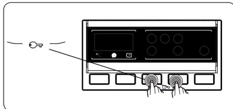
Mit der Kindersicherung lassen sich die Tasten sperren, sodass keine unbeabsichtigte Änderung des gewählten Waschgangs möglich ist.
