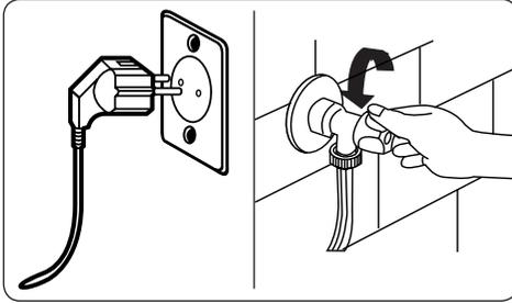
Schalten Sie Ihr Gerät aus und ziehen Sie den Stecker aus der Steckdose, bevor Sie Reinigungs- oder Wartungsmaßnahmen am Gerät durchführen.
