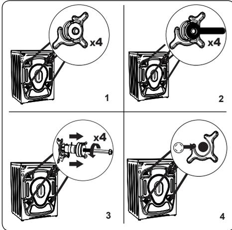
1. Entfernen Sie vor der Inbetriebnahme Ihrer Waschmaschine die vier Transportsicherungsschrauben und die Gummischeiben von der Rückseite des Geräts. Wenn die Transportsicherungsschrauben nicht entfernt werden, kann dies zu starken Vibrationen, Lärm und einer Fehlfunktion des Geräts sowie zum Erlöschen der Gerätegarantie führen.
