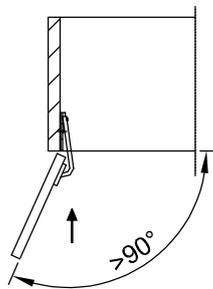
**T11** Bei Türmontage das Scharnier einhängen, bis Anschlag öffnen und anschließend festschrauben.
