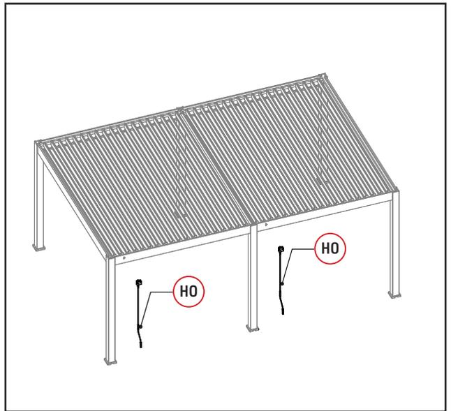
Schließen Sie die Verbindung der Lamellen ab.
