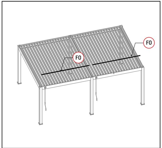
Schließen Sie die Verbindung der Lamellen ab.
