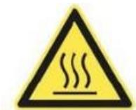
Bitte berühren Sie während des Gebrauchs nicht die Oberfläche. Die Temperatur der zugänglichen Oberflächen kann sehr hoch sein, wenn das Gerät in Betrieb ist.
