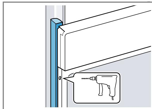
4. Das Gerät mit adäquater Schraube befestigen.
