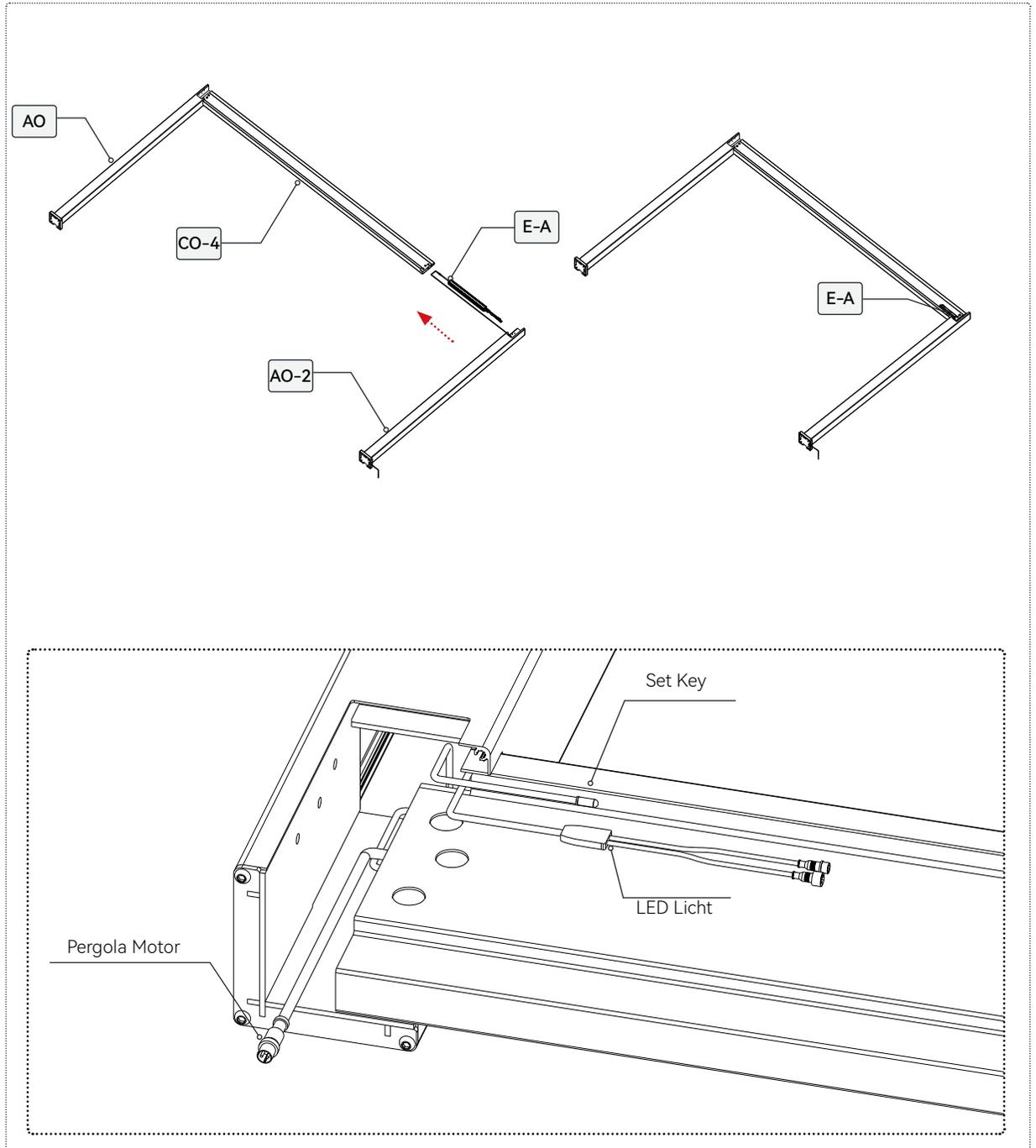
Installieren Sie die Schrauben für die Seitenbalken.
