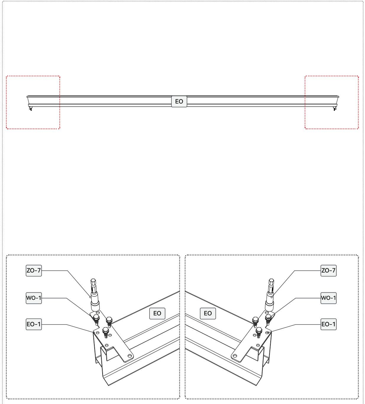
Befestigen Sie den Zwischenbalken mit den mitgelieferten Befestigungselementen am Zwischenpfosten. Achten Sie dabei auf die korrekte Ausrichtung, Stabilität und die richtige Platzierung des Balkens.
