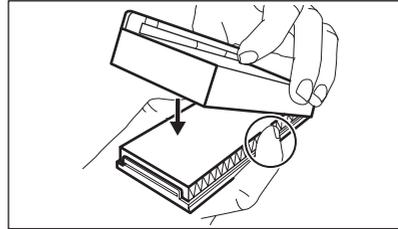
3. Nehmen Sie die obere Glasablage aus dem Kühlraum. Schieben Sie das Kunststoffgehäuse mit dem Luftfilter auf die linke Seite der Glasablage.
