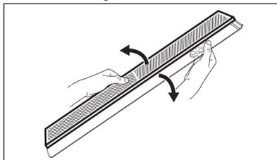
3. Setzen Sie eine neue Membran in die Abdeckung ein, indem Sie den Rand der Membran in die Abdeckung drücken.
