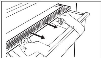
2. Um die weiße Membran des Geräts zu ersetzen, greifen Sie das Gerät in der Mitte und trennen Sie die Membran von der Abdeckung, indem Sie an der Abdeckung ziehen.
