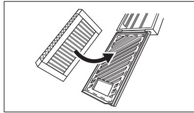
2. Halten Sie den Filter gedrückt, während Sie das Kunststoffgehäuse schließen, bis Sie ein Klicken hören.
