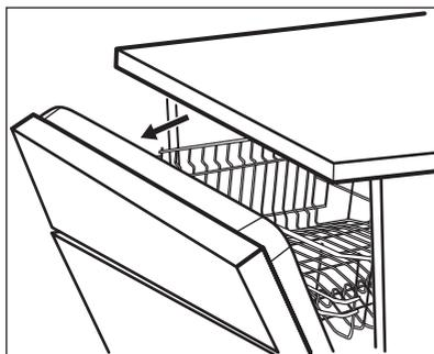
AirDry wird automatisch bei allen Programmen eingeschaltet.
