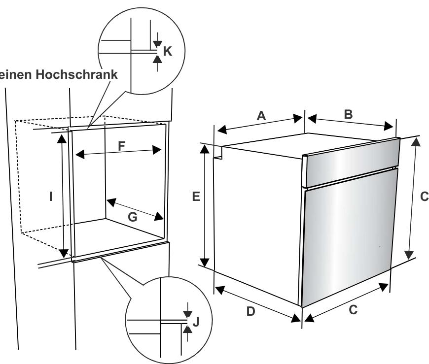
Nachdem alle elektrischen Anschlüsse ausgeführt wurden, den Backofen in den Einbauschrank einschieben. Die Backofentür öffnen, und die 2 Schrauben in die Löcher im Rahmen des Backofens einschrauben. Bei an der Schrankoberfläche anliegendem Geräterahmen die Schrauben festziehen.
