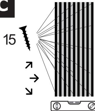
Mit Schrauben oder Kleber werden die Akustikplatten an der Wand montiert. Bei Montage an der Decke müssen immer Schrauben verwendet werden.
